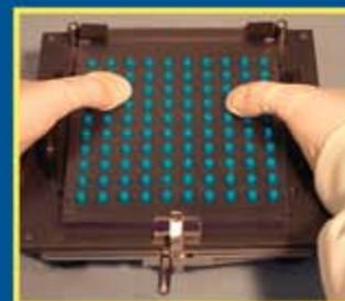
12. Установите верхнюю пластину на устройство наполнения. Для закрытия капсул сожмите верхнюю и нижнюю пластины.
