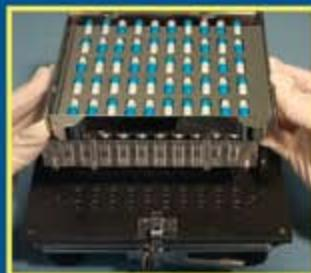
3. Откройте пластину для закрытия и установите Ориентатор на Наполняющее устройство в положение "I"
