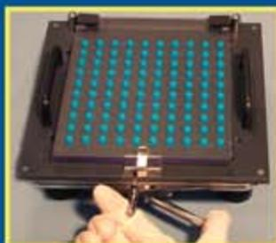
7. Закройте пластину для закрытия капсул и закройте замок. Переместите рукоятку запирающего устройства для фиксации тел капсул в наполняющем устройстве
