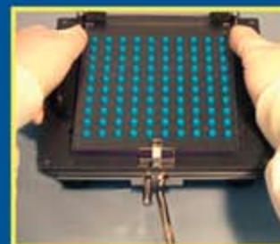
8. Для открытия капсул поднимите верхнюю пластину устройства наполнения капсул. После открытия капсул переместите рукоятку запирающего устройства в исходное положение, освободив тела капсул
