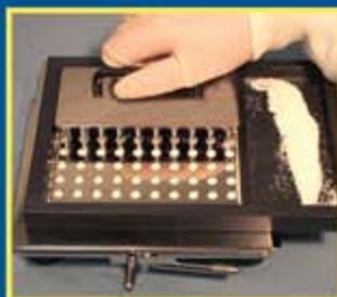
11. Используйте подпрессовщик порошка для равномерного заполнения капсул. После того, как все капсулы наполнены, снимите рамку для порошка
